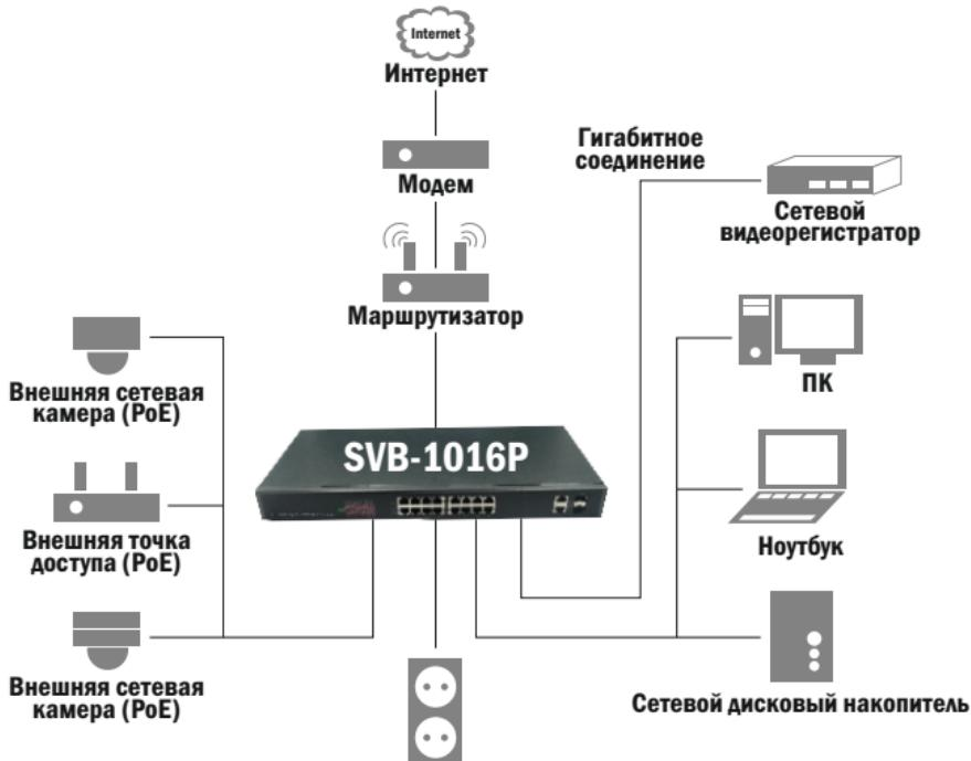
Подключите адаптер питания 48V к вашей электрической сети, для этого возьмите шнур с вилкой 220V и соедините его с розеткой. Другой конец адаптера подключите в разъём на коммутаторе. Загорится индикатор «Power», значит питания подается исправно.
