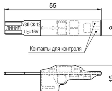
Рис.1 Габаритные размеры УЗЛ-СК-12 (УЗЛ-СК-24)
